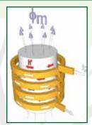
El proyecto INDUFOOD pretende buscar alternativas a los actuales sistemas térmicos por medio de la utilización de la tecnología de inducción. En una configuración básica de calentamiento por inducción, una fuente de alimentación genera una comiente alterna que atraviesa un inductor (normalmente una bobina de cobre) y la pieza a calentar se sitúa
